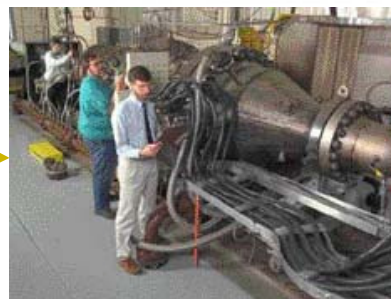
Testes em RIG de Componentes e APU
